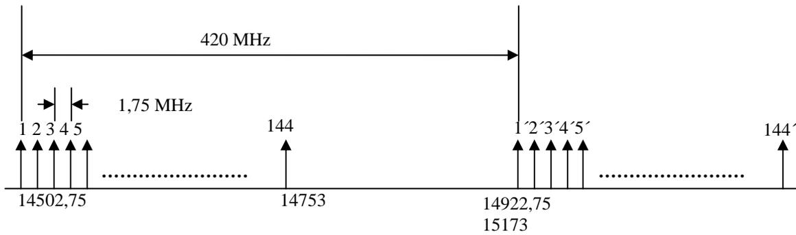
Al efectuar la asignación de frecuencias se trata en lo posible de agrupar los sistemas conforme a su capacidad a fin de buscar el máximo de aprovechamiento en el uso del espectro, a tal fin debe utilizarse la parte superior de la banda para los sistemas de mayor capacidad agrupando los de menor capacidad en la parte inferior.
